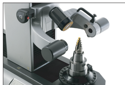
Detail výklopné kamery Zoller pro kontrolu geometrie nástrojů
