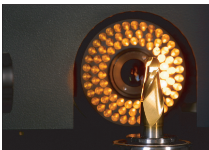
Segmentové prstencové LED osvětlení přístroje Zoller Genius 3
