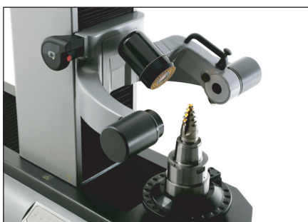
Měřicí přístroj Zoller SmarTcheck s výklopnou kamerou pro měření i velmi komplikovaných nástrojů
