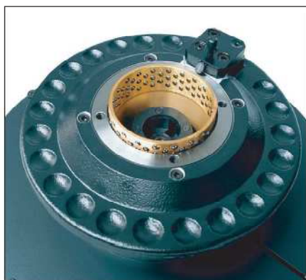
Upínací vřeteno A.C.E. s originálním systémem výměny držáků
