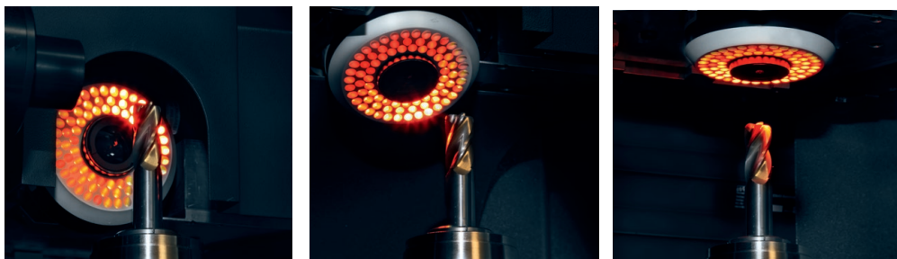
Výklopná CCD kamera pro měření v násvitu umožňuje radiální a axiální měření (výklopná 0° až 90°)
