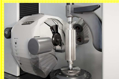
Měřící, seřizovací a kontrolní přístroj Zoller »hobCheck« pro komplexní proměření a kontrolu odvalovacích fréz
