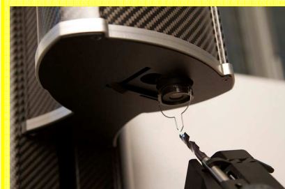
Měření zaoblení rezné hrany osových nástrojů i destiček pomocí přístroje ZOLLER »pomSkpGo«
