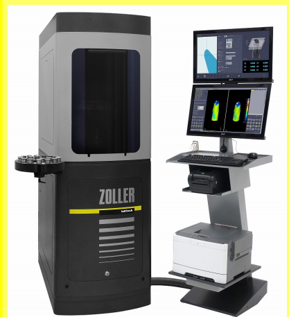
Měřicí a kontrolní přístroj Zoller »threadCheck« pro komplexní proměření a kontrolu závitových nástrojů
