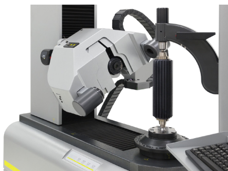
CNC-řízené výklopné rameno s optikou
