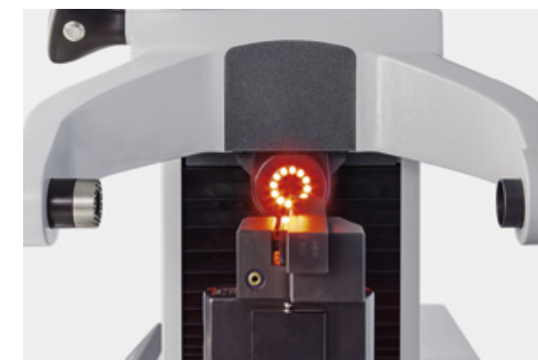
Kamera pro kontrolu středu obrábění na ramenu optiky s LED prstencovým světlem
