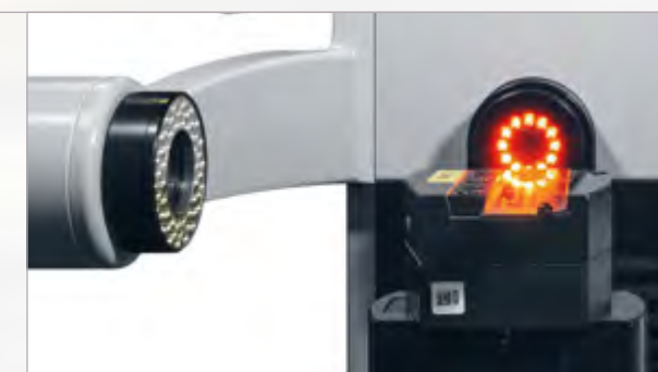
Kamera pro kontrolu středu obrábění v ramenu optiky s LED prstencovým světlem
