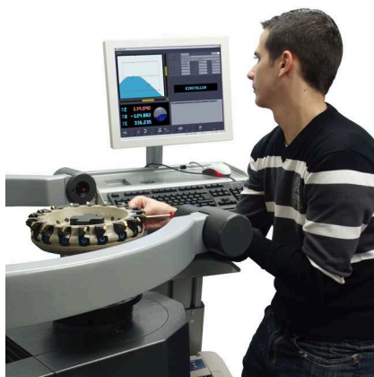
Ideální přístupnost k vřetenu zajišťuje pohodlné seřizování břitů nástroje
