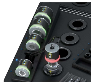
obr. 7 chladicí zvony s naváděním uživatele »coolbyLight« - pomocí barevného LED systému zajišťují pro uživatele bezpečnost chladicího procesu
