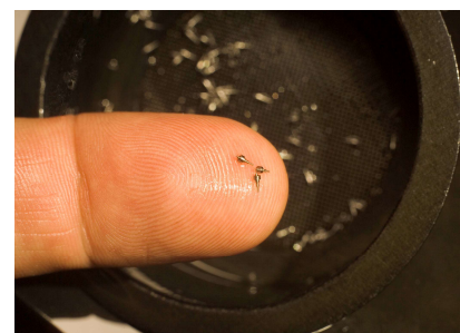
obr. 10 malé díly vyráběné na soustruhu, nástroje seřizené na přístroji »hyperion«
